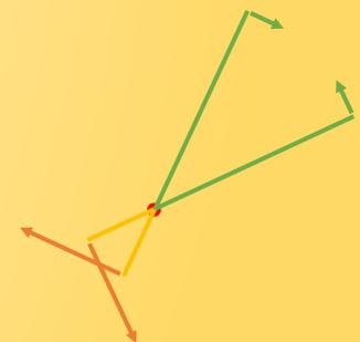
Zangen und Scheren bestehen oft aus zwei zweiseitigen Hebeln.
